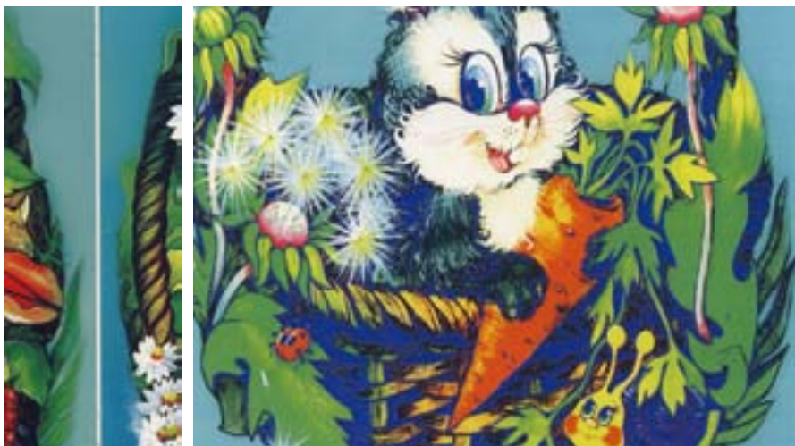
Links: Weißer unbedruckter Strich am Rückenfalz. Rechts: Farbbelegung größer als 350 Prozent an dunkelblauen (Markierungsfarbe) Bereichen.
