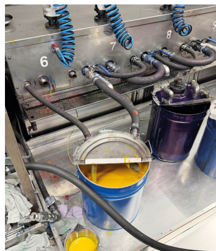
Abbildung 1 Flexodruckfarbe Gelb am Druckwerk, hier wurde der Farbwechsel Gelb – Schwarz – Gelb durchgeführt.
