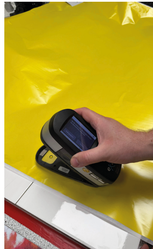
Abbildung 4 Messung der Farbdifferenz nach dem Rückwechsel auf Gelb; gemessen wurde \Delta E = 0,85 .
