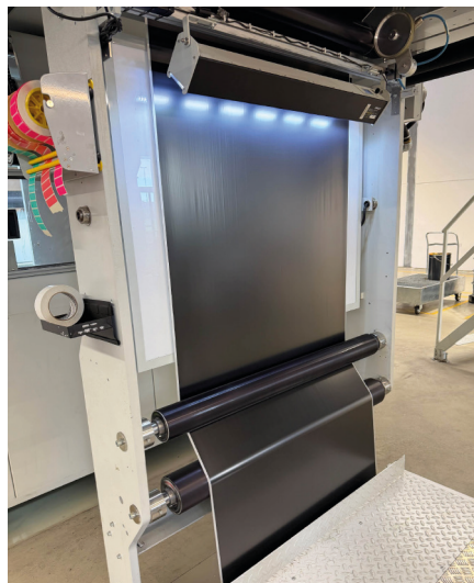
Abbildung 3 Vollflächiger Druckabzug mit Schwarz nach dem Umwaschen.
