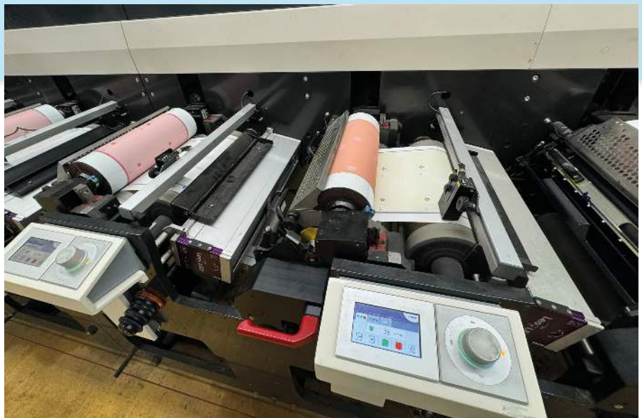
Abbildung 1 Flexodruckmaschine zum Bedrucken der Selbstklebeetiketten samt UV-Lack.
