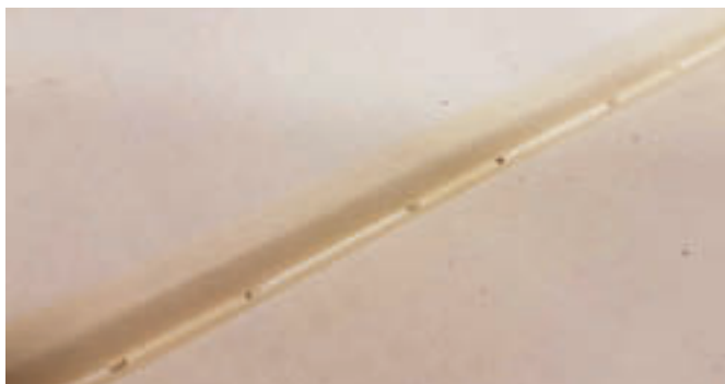
Abbildung 5: »Faksimile 1« mit maschineller Fadenheftung in straffer, sehr guter Qualität.
