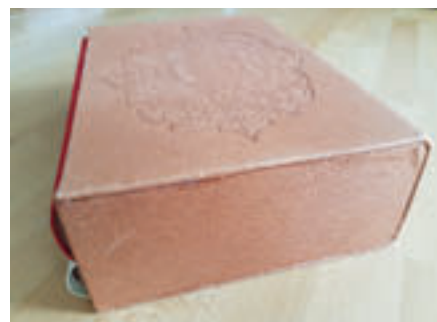
Abbildung 8: Schuber mit Leimflecken und Kratzer, Leder in minderwertiger Qualität.
