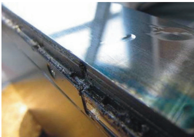
... und beschädigte Nozzleplatte.
