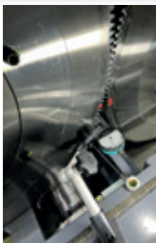
1. Vermessung des Planlaufs am Zahnrad des Transferzylinders eines Druckwerks.
