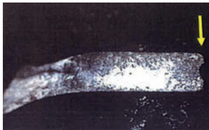
Bild 2 | Spurenlage des Sicherungsdrahts einer Feinsicherung.
