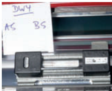
Präzisionswasserwaage am Gegendruckzylinder eines Druckwerks.
