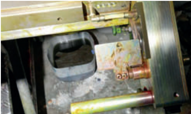
Schlauchstück für Waschmittel und Wasser (Emulsion) war zu kurz.
