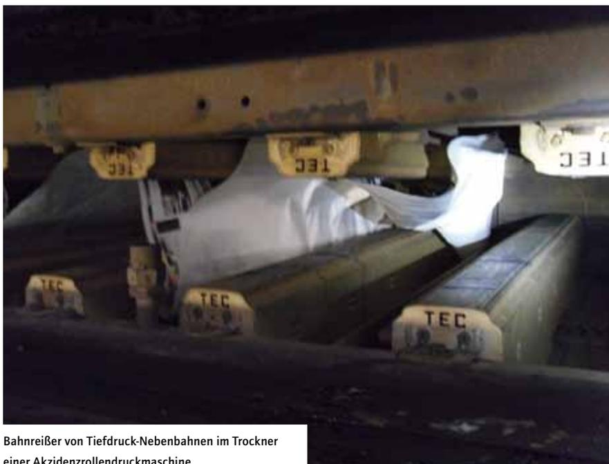
Bahnreißer von Tiefdruck-Nebenbahnen im Trockner einer Akzidenzrollendruckmaschine.
