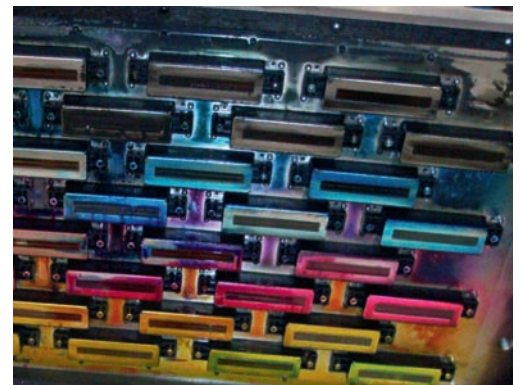
Abbildung 2: Deutlich erkennbar – der Druckschlitten mit einzelnen Druckköpfen.
