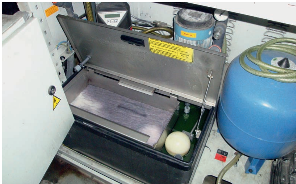
Feuchtwasser des Umlaufs dringt über einen längeren Zeitraum unbemerkt in den Ölkreislauf der Druckmaschine ein und verursacht dort Korrosion.
