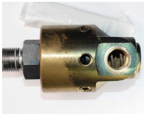
Abbildung 2: Dreheinführung des Kühlwassers in einen Farbreiber.
