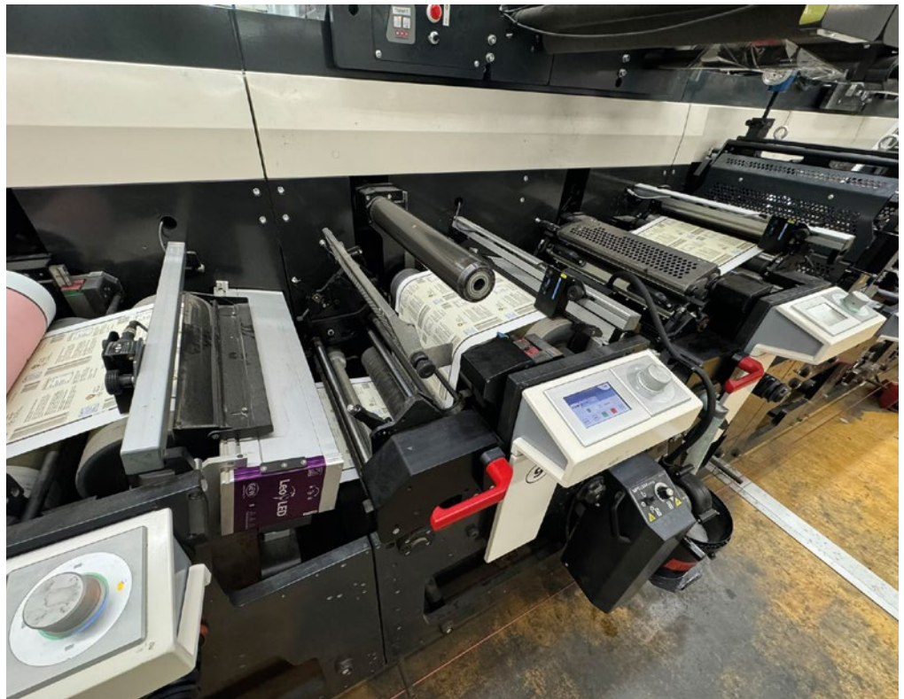
Abbildung 1: Flexo-Druckwerke für die Etikettenproduktion.
