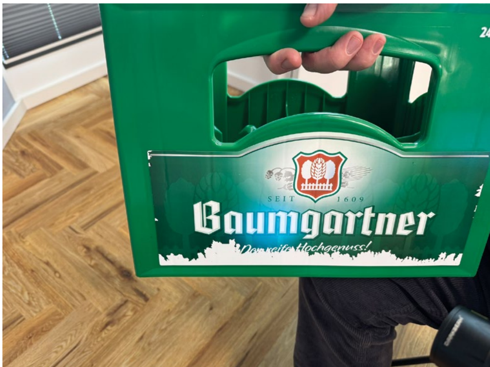
Abbildung 2: Abgescheuerte Farbe an Etikett wegen fehlendem Primer.
