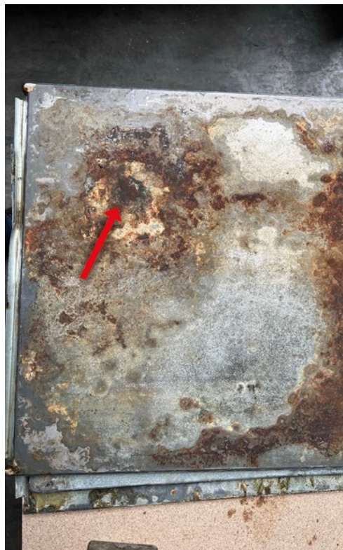
Abb. 3: Stark korrodiertes Bodenblech hin zur Fundamentbodenplatte (roter Pfeil: Position des Stellfußes auf der Rückseite des Bleches).
