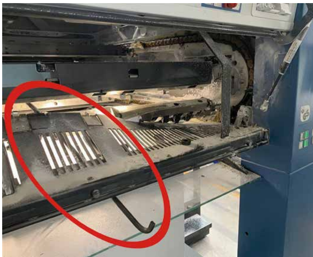
Abb. 1: Eisenstange verfängt sich in der Bogenauslage.
