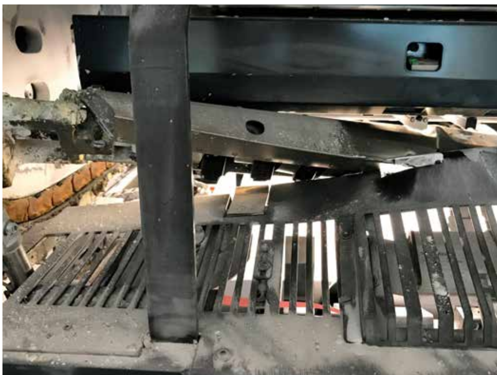
Abb. 2: Stark verbogener Greiferwagen in der Bogenauslage.
