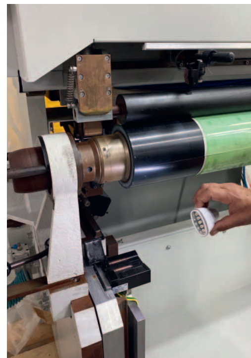
Abbildung 3: Plate Mounter mit brandbedingt korrosiv angegriffenen Metalloberflächen.
