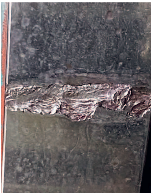
Abbildung 1: Ausbruch an Lauffläche des Schmitzringes (links), Ausbruchteil mit sichtbarer Lauffläche (rechts, oben) und Ausbruchteil mit sichtbarer Bruchfläche (rechts, unten).
