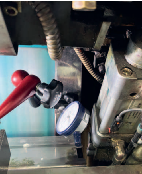
Abbildung 3: Messuhr zur Rundlaufvermessung der Schmitzringlauffläche.
