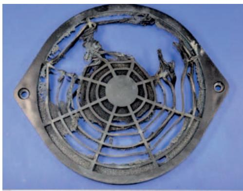
Abbildung 2: Lüftungsgitter aus Kunststoff, abgebaut von Traverse hinter dem Druckschlitten.
