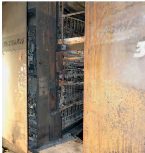
Abgebrannte Akzidenz-Rollendruckmaschine, unmittelbar nach gelöschtem Brand.
