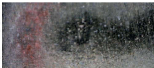
Abbildung 2: Pustel ähnliches Aussehen (50-fach vergrößert) mit eingelagerten Korrosionsprodukten.
