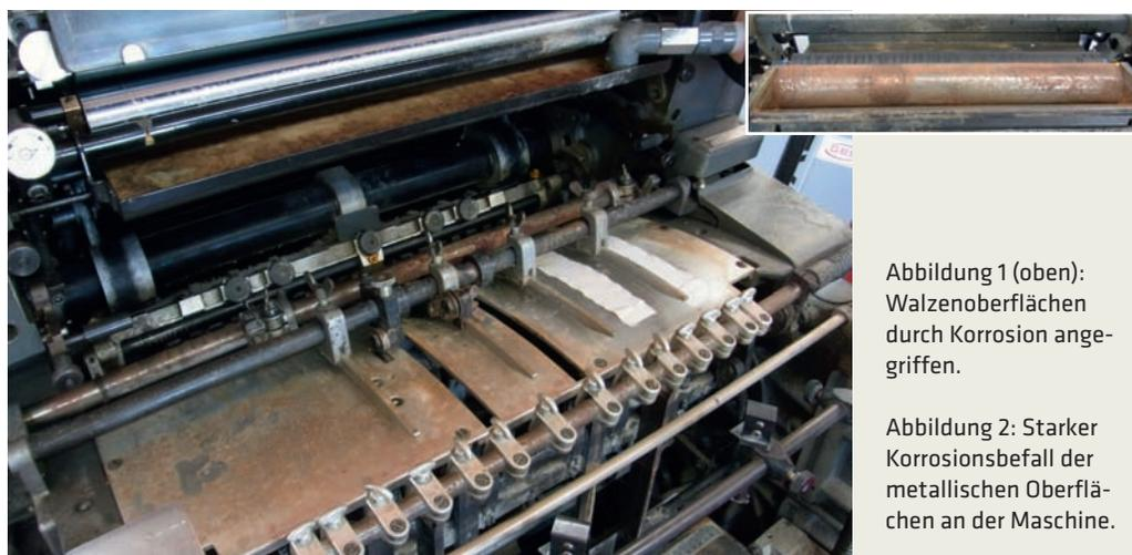
Abbildung 1 (oben): Walzenoberflächen durch Korrosion angegriffen.
