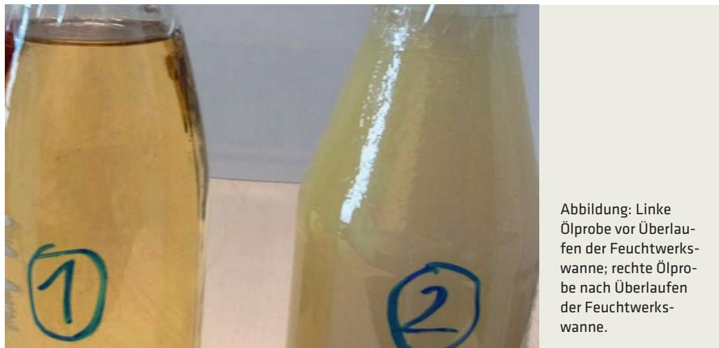
Abbildung: Linke Ölprobe vor Überlaufen der Feuchtwerkswanne; rechte Ölprobe nach Überlaufen der Feuchtwerkswanne.
