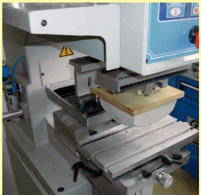
Tampondruck- maschine mit zu kleinem Druckformat.
