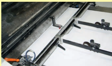
Der Bogenanleger begrenzt unter anderem die Produktionsgeschwindigkeit.
