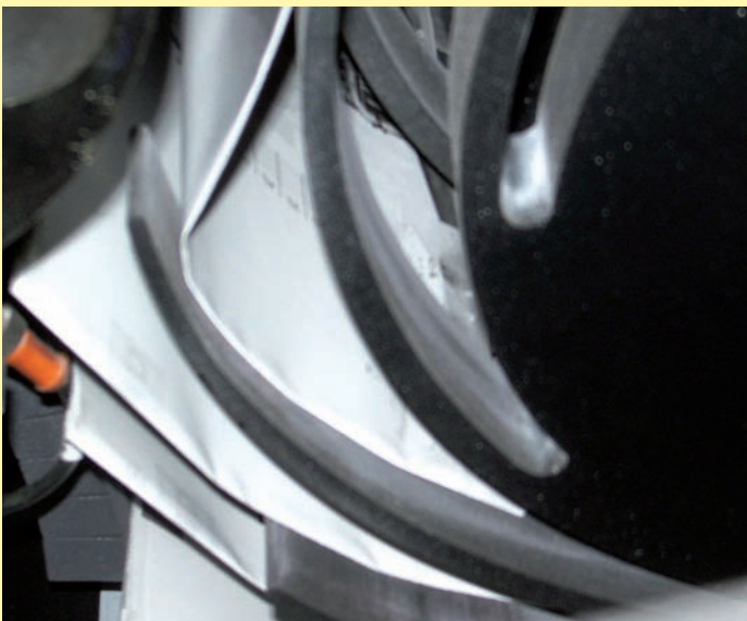
Die Abbildung zeigt Druckprodukte bei der Übergabe ins Schaufelrad.
