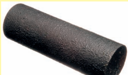
Abbildung 1a: Eisengussprobe von der Außenseite der Seitenwand.
