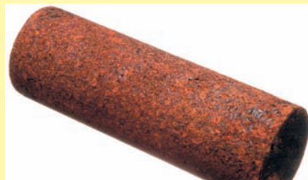
Abbildung 1b: Eisengussprobe von der Innenseite – mit Korrosionsbefall.
