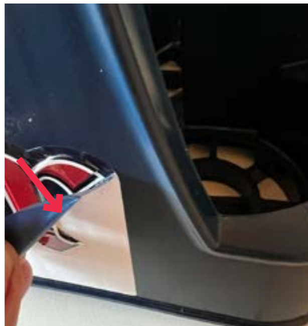
Abb. 1: Kaschierfolie mit Druck löst sich (roter Pfeil) vom ursprünglichen Bedruckstoffmaterial der Etiketten
