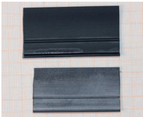
Abbildung: Probe 1 (Viton) mit Ausgangslänge der Probe von 35 mm, Längenzunahme nach dem Einlegetest etwa 4 mm (obere Probe) bei Beaufschlagung durch UV-Waschmittel.
