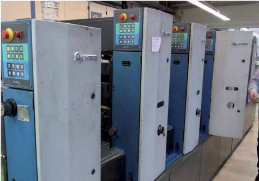
Bogendruckmaschine mit Störungen im Versorgungsnetz.
