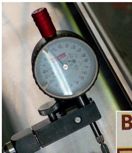
Abbildung: Messuhr der Auflösung 1 µm im Messständer bei der Rundlaufmessung eines Gegendruckzylinders.
