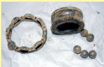
Abbildung 1: Kugellager mit gelblichen, spröden Belägen.
