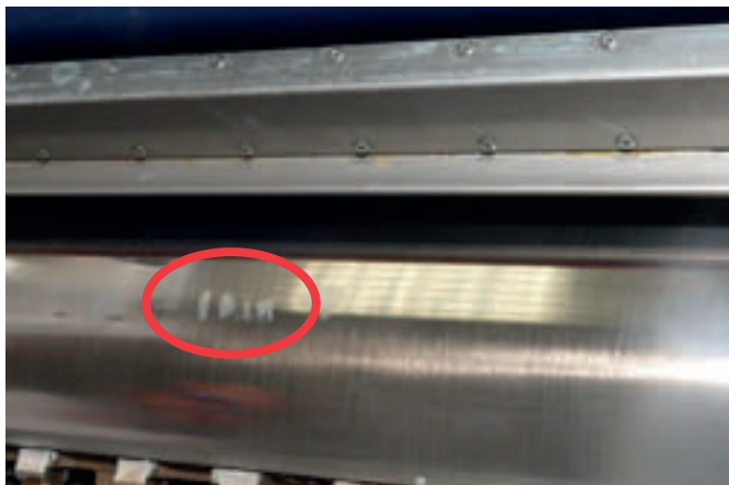
Beschädigungen (rote Markierung) an der reparierten Hartchromschicht des Gegendruckzylinders des Lackwerks der Bogendruckmaschine.
